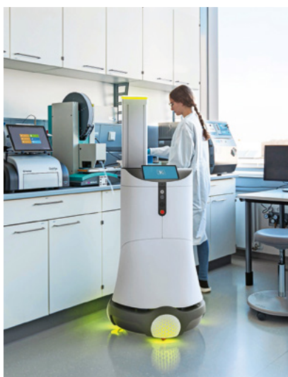
Der mobile Laborroboter Kevin ermöglicht automatisierte Arbeitsabläufe im Labor.
